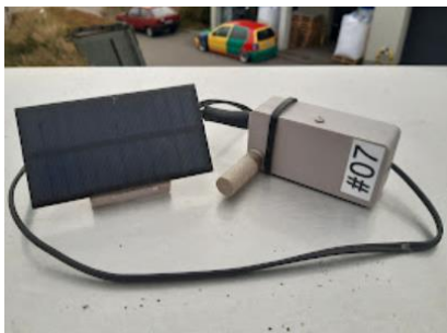
Prvky pro řízení průtoku vzduchu větranou mezerou – datalogery vlastní výroby s FV napájením a WiFi komunikací, osazení v mezeře u atiky
