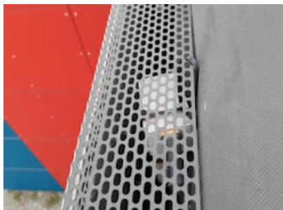
Prvky pro řízení průtoku vzduchu větranou mezerou – datalogery vlastní výroby s FV napájením a WiFi komunikací, osazení v mezeře u atiky
