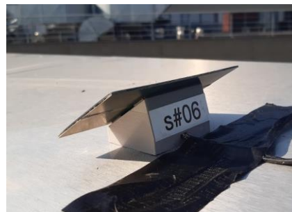
Prvky pro řízení průtoku vzduchu větranou mezerou – datalogery vlastní výroby s FV napájením a WiFi komunikací, osazení v mezeře u atiky
